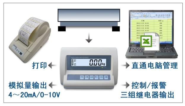
HZ3100N 是以 MCU 为核心,采集应变传感器信号,经 ADC 电路转换,实现称重管理。
